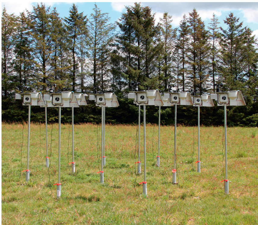
Figur 2. Tolv klimastationer opsat ved forsøgsarealet ved Arnborg.
